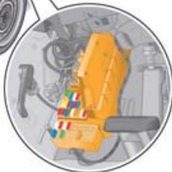
Bordnetzsteuergerät J519, an der A-Säule links
