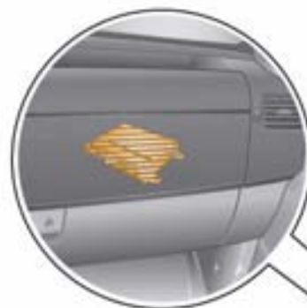
Steuergerät für Bedienungselektronik des Handys J412, hinter dem Handschuhfach
