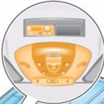
Steuergerät für Zusatzheizung J364, im Fahrzeughimmel nahe Innenspiegel
