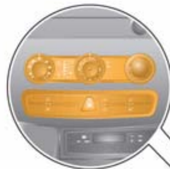
Bedienungseinheit für Schalttafel Mitte J819, in der Schalttafelmitte
