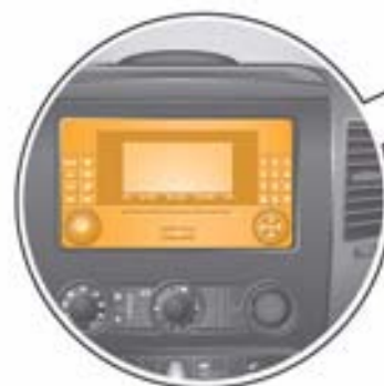
Steuergerät mit Anzeigeeinheit für Radio und Navigationssystem J503/Radio R, in der Schalttafelmitte
