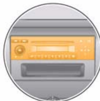
Radio R/Steuergerät mit Anzeigeeinheit für Radio und Navigationssystem J503 *, in der Schalttafelmitte
