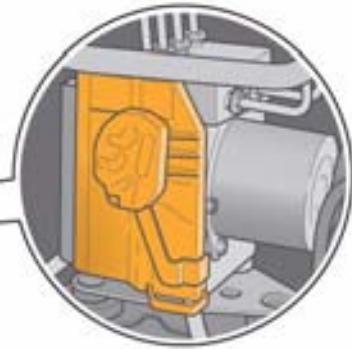
Steuergerät für ABS J104, im Motorraum links
