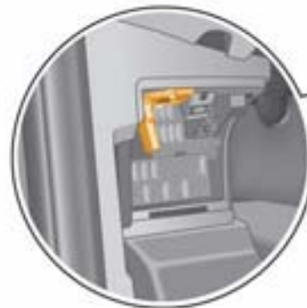
Steckverbindung (T16) Diagnoseanschluss, an der A-Säule links
