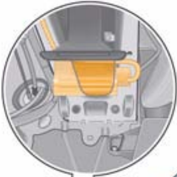
Steuergerät für Airbag J234, unter der Mittelkonsole
